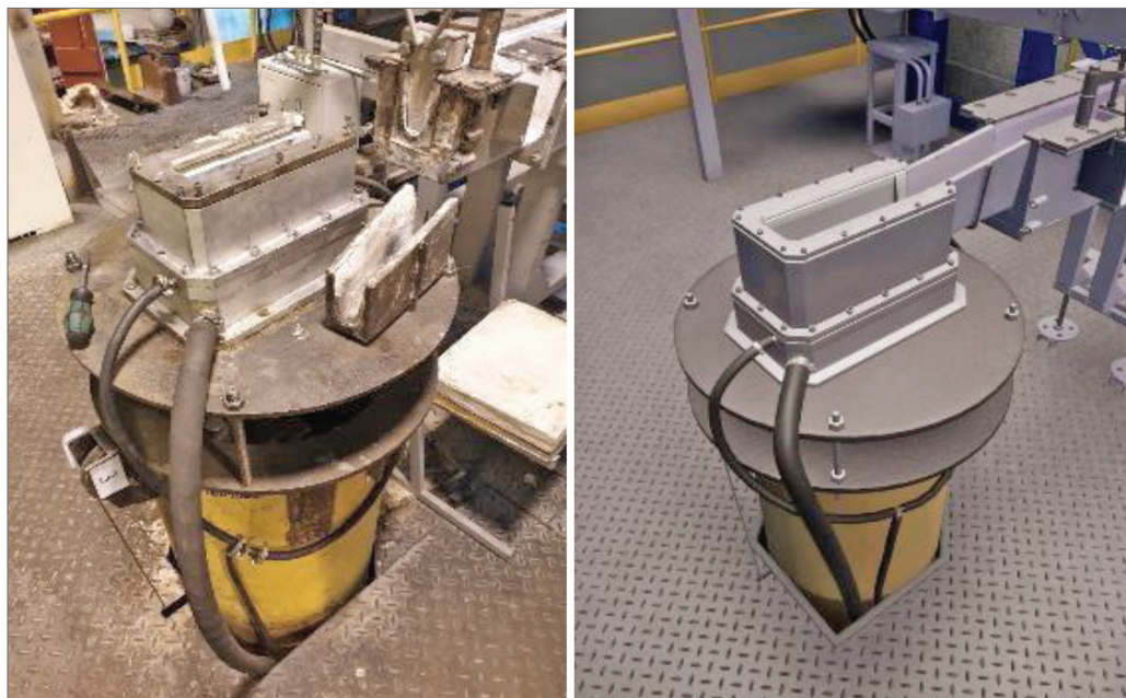
Рис. 3. Кристаллизатор (а) и скриншот его виртуальной модели (б) Fig. 3. Crystallizer (a) and a screenshot of its virtual model (b)
